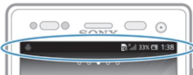
Строка состояния позволяет произвести настройку основных параметров устройства, например, Wi-Fi®, Bluetooth™, передачу данных и звук. Чтобы поменять остальные параметры телефона, можно также открыть меню параметров из панели уведомлений.
